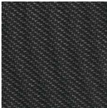
Glasvezeldoek Doek, gemaakt van PVC-gecoate glasvezelgarens, weefsoort Sergé.
